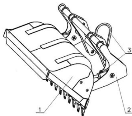
Рис. 4.61. Ковш высокой разгрузки в открытом положении
