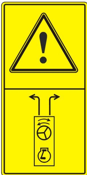
Система поворота действует только при работающем двигателе
