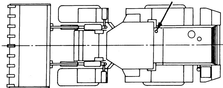
Рис. 5.23. Расположение бачка с тормозной жидкостью на машине
