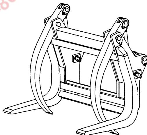
Рис. 6.7. Захват CH-3.1
