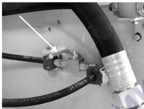
Рис. 4.24A. Рычаг клапана аварийного опускания стрелы
