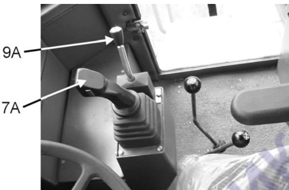
Рис. 4.2а. Рычаг управления рабочей системой
