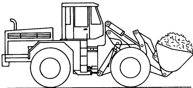
Рис. 4.33. Движение с наполненным ковшом
