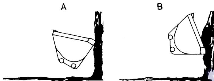
Рис. 4.31. Загрузка ковша с вертикальной стеной
