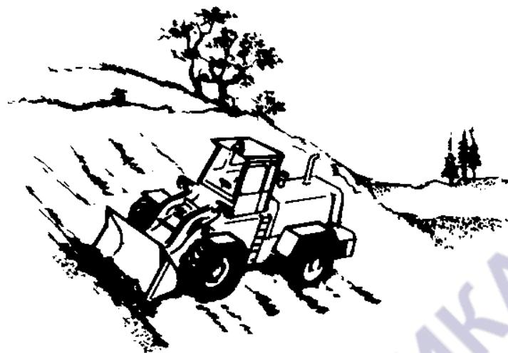
Рис. 4.17. Парковка машины на склоне
