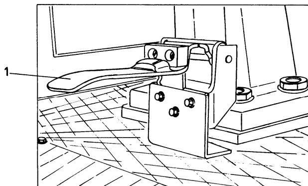
Рис. 4.11. Фиксатор двери кабины
