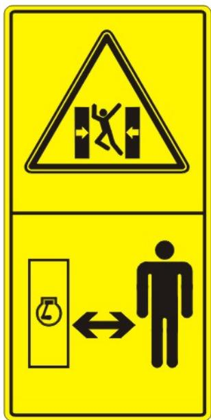
5. - Табличка безопасности – шарнирное соединение рам машины (с обеих сторон машины)
