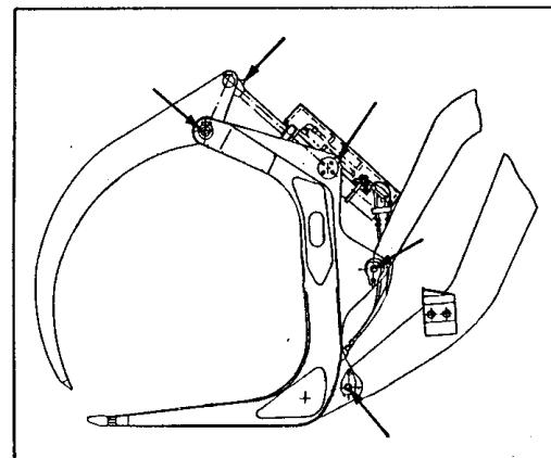
Рис. 5.12А. Масленки шкворневых соединений захвата (если установлен захват)
