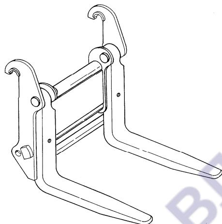
Рис. 6.9. Вилы (для быстроразъемного соединения)
