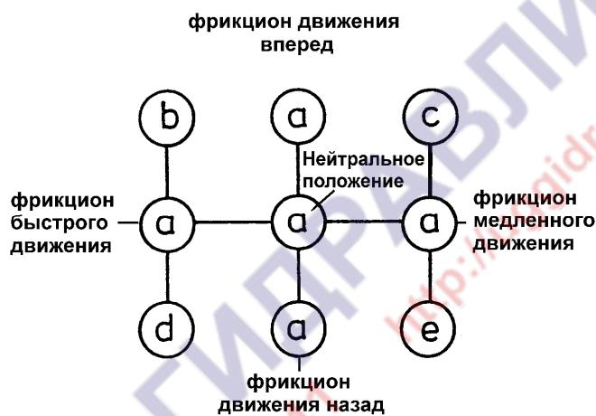
Рис. 5.69. Положение рычага управления распределителем коробки передач
