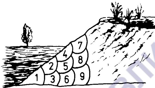
Рис. 4.40. Отработка уступа
