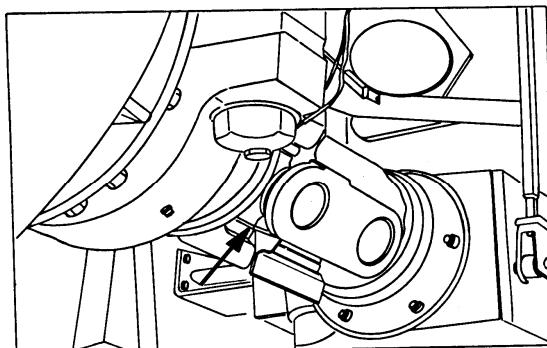
Рис. 5.3. Масленка вала «коробка передач – задний мост»
