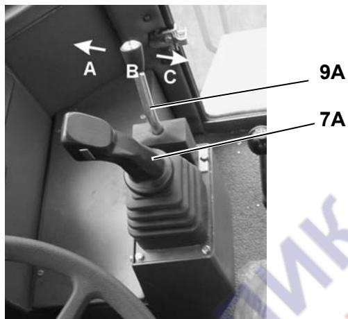
Рис.4.63. Положения рычага управления движениями ковша высокой разгрузки
