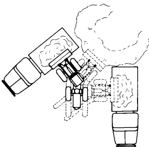
Рис. 4.25. Загрузка способом «V»
