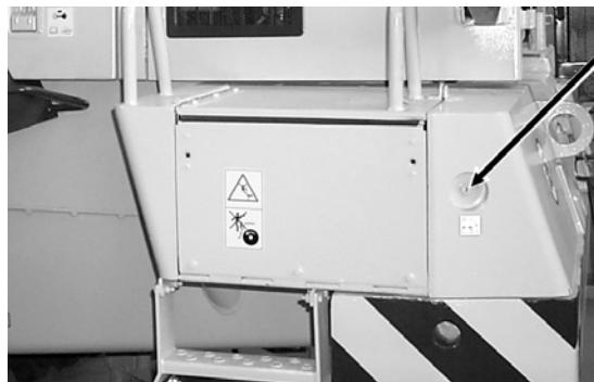
Рис. 4.13. Главный выключатель системы электрооборудования
