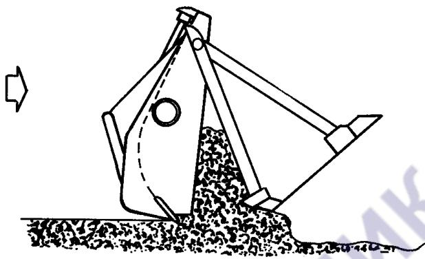
Рис. 4.48. Расстилка материала с помощью многооперационного ковша
