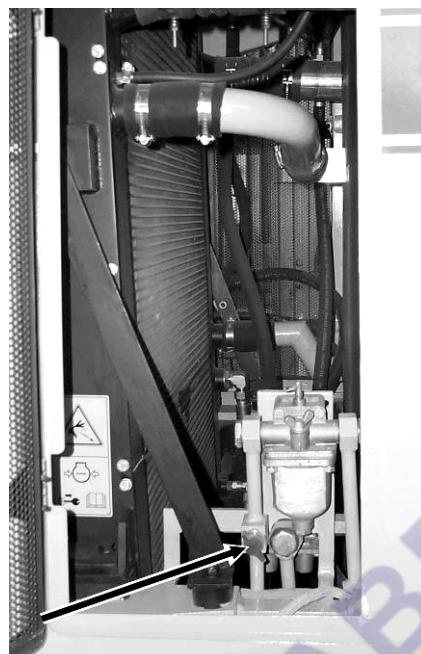
Рис. 5.19. Клапан отбора воздуха для накачки шин
