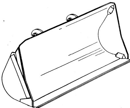
Рис. 6.10. Ковш для камней (для быстроразъемного соединения)
