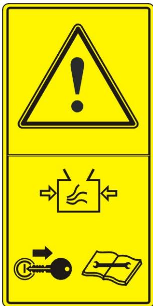
**Опасность** повреждения кожи тела под воздействием давления струи сжатого воздуха. Воздушный резервуар находится под воздействием внутреннего, избыточного давления.
