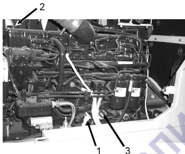
Рис. 5.38. Проверка уровня масла в масляном поддоне двигателя
