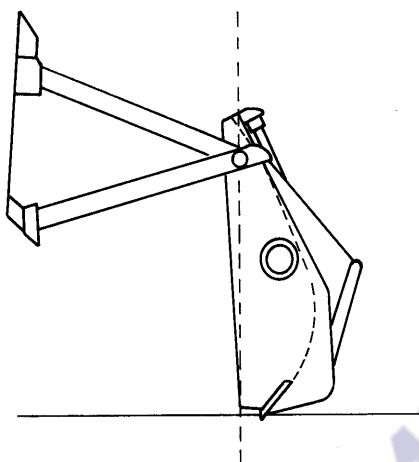
Рис. 4.42. Многооперационный ковш в положении бульдозерного отвала
