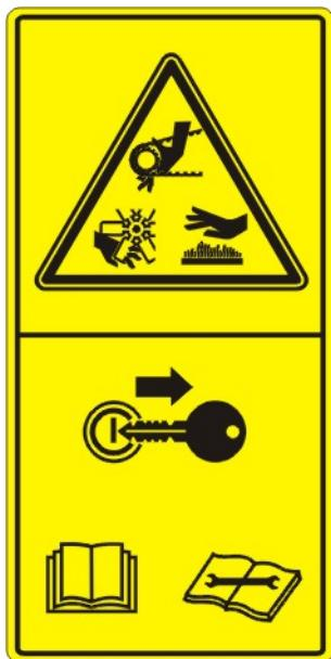
**Опасность** отсечения или повреждения пальцев или кисти руки элементами привода вентилятора двигателя, а также опасность ожога пальцев или кисти руки горячими деталями газовыпукского тракта двигателя.
