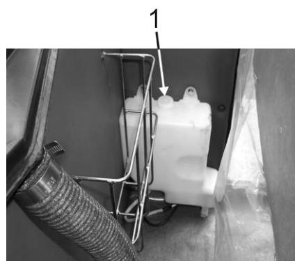
Рис. 5.76. Резервуар спреера
