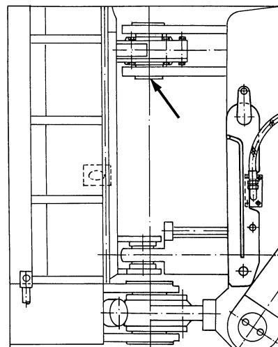
Рис. 5.8. Масленка конических подшипников нижнего шарнира рамы
