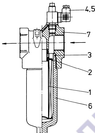
Рис. 5.60. Фильтр гидросистемы поворота напорный
