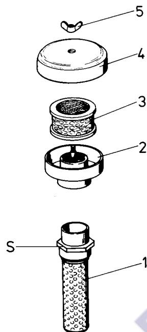
Рис. 5.61. Сапун масляного бака рабочей гидросистемы
