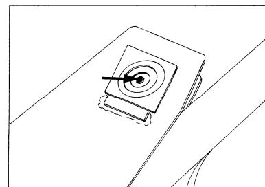
Рис. 5.14. Масленки шкворневых соединений поворота тяг относительно рычагов
