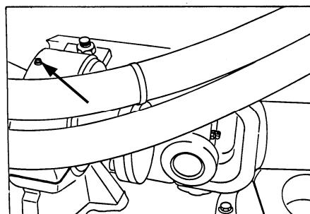
Рис. 5.10. Масленка подшипника промежуточной опоры карданных валов привода переднего моста
