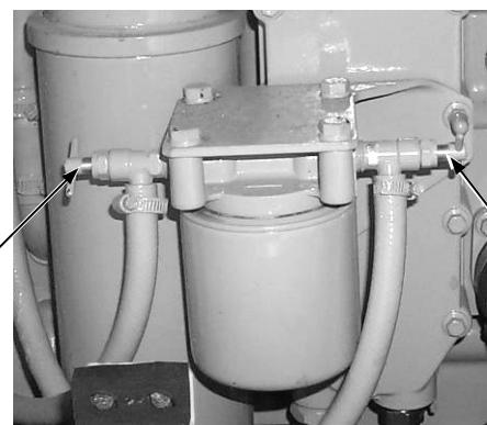
Рис. 5.32. Клапана отсечные фильтра охлаждающей жидкости
