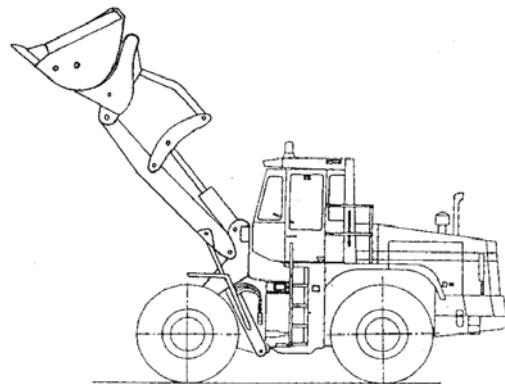
Рис. 4.65. Ковш высокой разгрузки в закрытом положении
