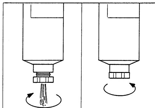
Рис. 5.54. Слив отстоя из сепаратора топливного фильтра
