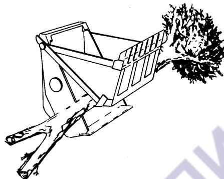
Рис. 4.35. Транспортировка деревьев с помощью многооперационного ковша
