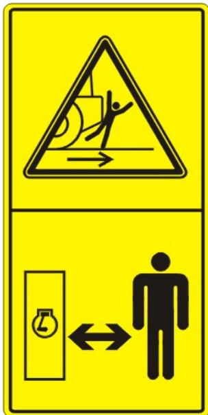
**Опасность** наезда машиной при ее движении задним ходом.
