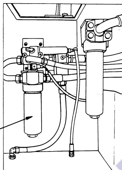
Рис. 5.66. Расположение на машине напорного масляного фильтра трансмиссии (в отсеке правого масляного бака)
